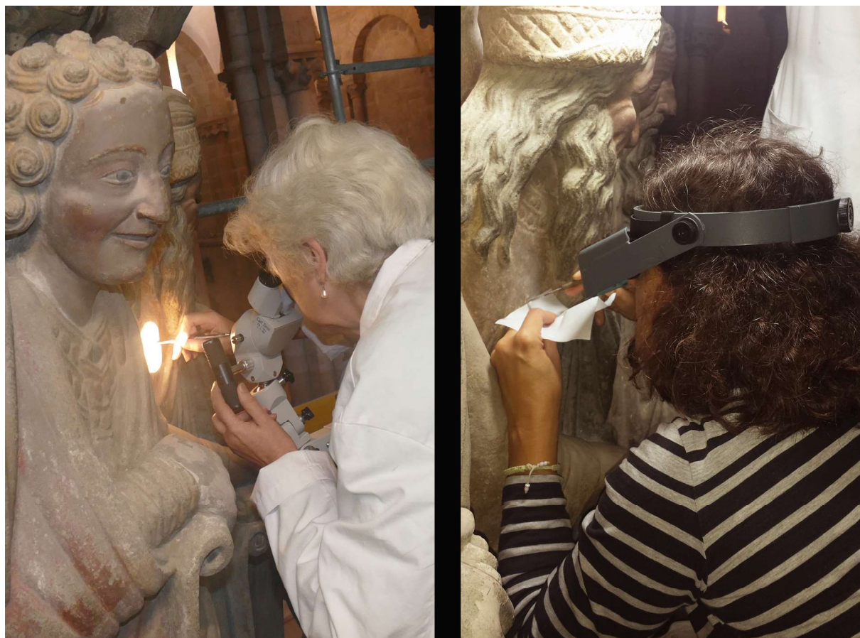
Figura 4. Observación con microscopio estereoscópico de las distintas capas de policromía para establecer la correspondencia de los estratos históricos (izquierda) y posterior toma de muestra empleando unas gafas de aumento (derecha) en el Pórtico de la Gloria (catedral de Santiago de Compostela).
